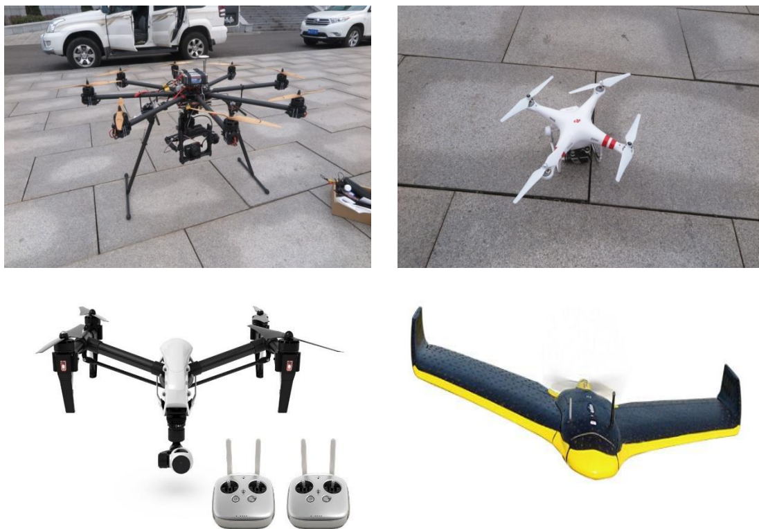
图 2-3 8 轴无人机、4 轴无人机和 ebee 无人机
